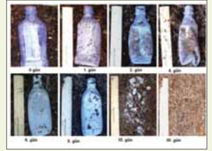
Şekil 8. 30 gün boyunca çürüme koşullarına maruz kalmış poli(laktik) asitten üretilmiş şişeler; 58 ± 5°C & 60 ± 5%RH (Kale et al 2006 [15])
