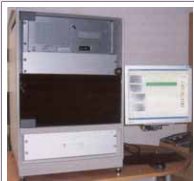
Resim 6: DotScan ölçüm aletinin geliştirilmesi sırasında özellikle pratik görüşler dikkate alınmıştır. Olabildiğince küçük boyutlu bir birimin üst kısmında güçlü bir IPC, ve onun altında da içinde bir kamerayı ve ışık kaynaklarını barındıran ölçüm haznesi vardır. En altta, içine test örneklerinin konulduğu çekmece görülmektedir. Bir otomatik ölçümü mümkün kılmak için bu çekmece yerine bir yükleme birimi de yerleştirilebilir.
