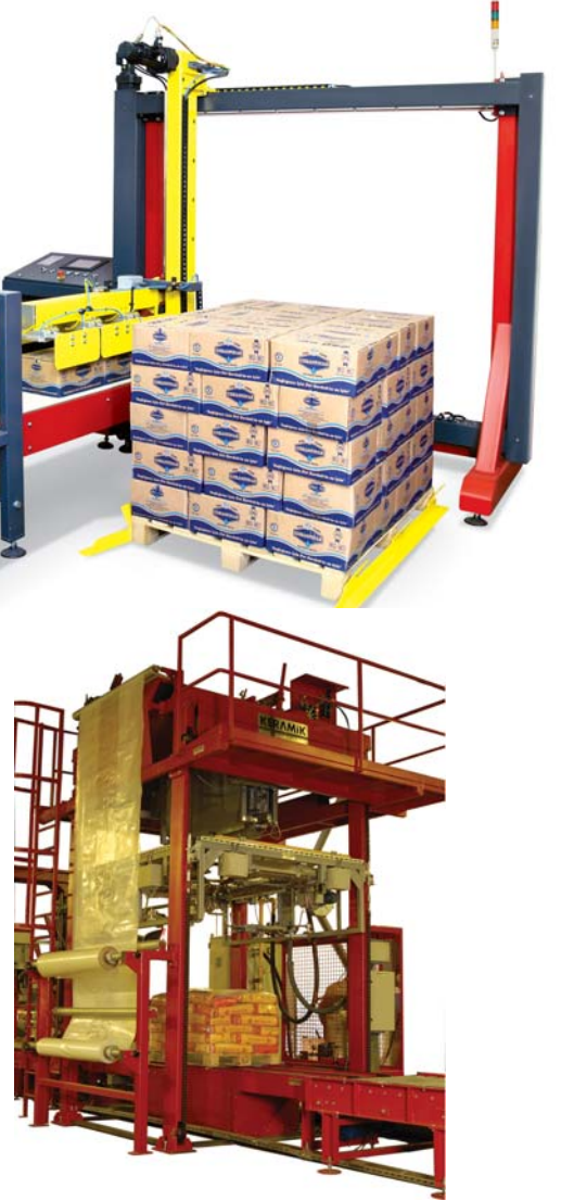
Tam otomatik paletleme makinesi – İmalatçı: Keramik
